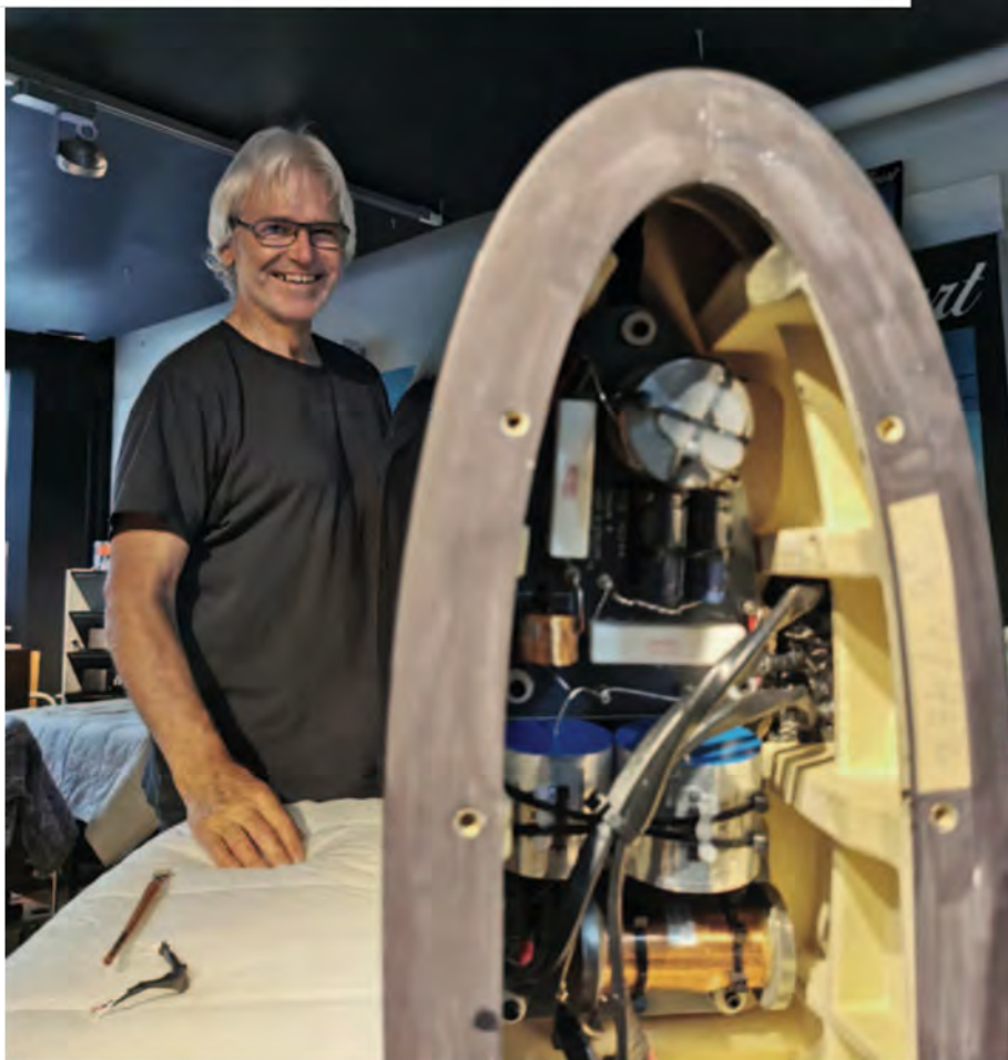
DER CHEF AM WERK: Christian Rohrer vor dem geöffneten Sockel der KEF Blade mit einem Teil der komplexen Frequenzweiche und der neu verlegten Kabel.
