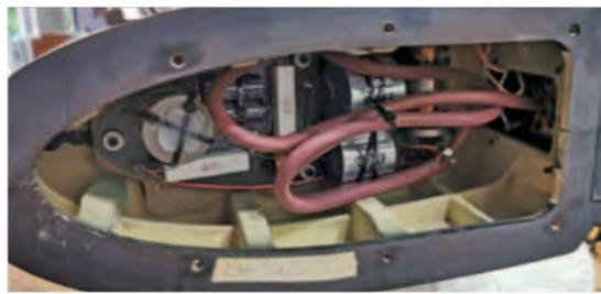
**WEICHE IM WECHSEL:** Im Inneren der KEF Blade geht es dichtgedrängt zu. Hier der Blick auf die nach original verkabelte Bassfrequenzweiche.
