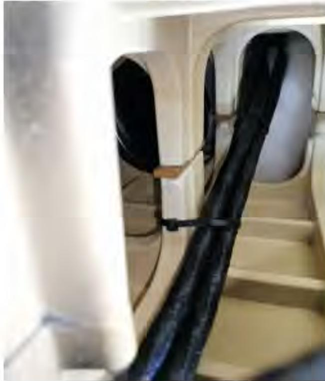
Der Blick in das Innere der crTech-modifizierten KEF Blade zeigt die neu verlegten Kabelstränge. Es kommen hochwertigste Leiter vom Typ Soundway LS60s MK II zum Einsatz, die zusätzlich mit einer Isolation resonanzbedämpft werden.
